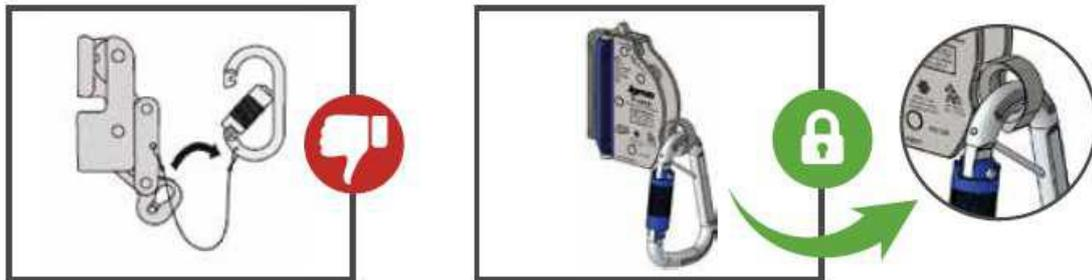
3) La utilización de perillos/sujetacables para fijar el cable en el anclaje superior **No está permitido**.
